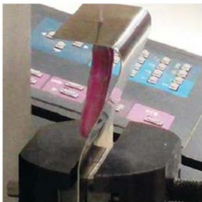
Test odolnosti šňůrky tampónu probíhal ve speciálním přístroji, dynamometru.
