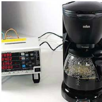
Měření spotřeby elektrické energie při přípravě kávy.
