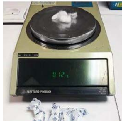
Vlákna, která se během zkoušky zachování struktury uvolnila z tampónu, jsme zvážili.
